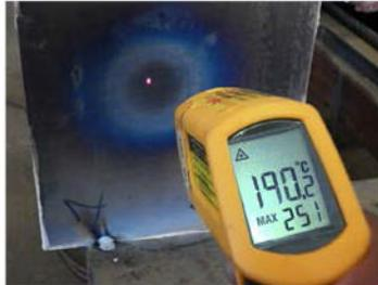
\*Temperatura Posterior de Placa de Acero de 1/2" con fuego directo de Soplete durante 3 hrs., recubierta con **Aislacreto Intumescente**.
