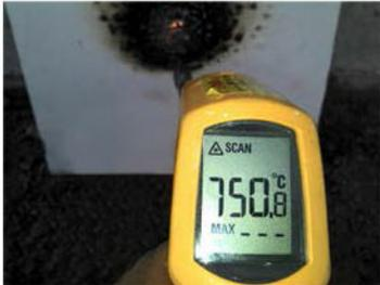
\*Temperatura Frontal de Placa de Acero de 1/2" con fuego directo de Soplete durante 3 hrs., recubierta con **Aislacreto Intumescente**.
